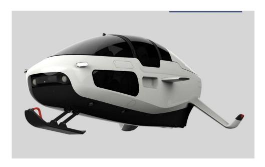
Um dos pontos de destaque é o fato dele retirar o oxigênio da água do mar, dessa forma os passageiros não precisariam de cilindros de oxigênio para respirar. Segundo os desenvolvedores, esse processo requer energia mínima, o que é importante, pois o DeepSeaker DS1 é um dispositivo 100% elétrico.
